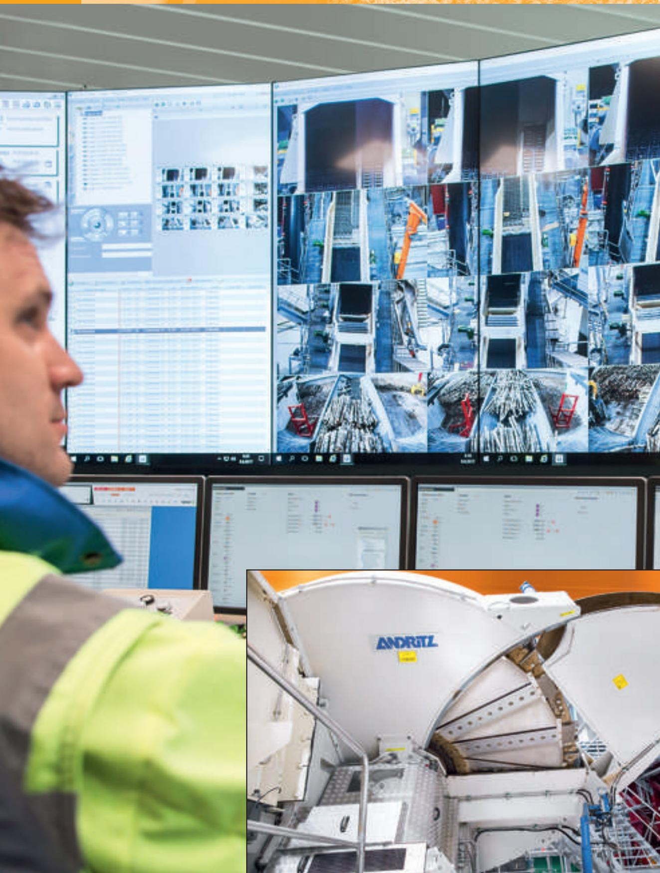
**State of the Art: Online-Überwachung der gesamten Anlage mittels ANDRITZ-iiOT-Lösungen. Von einer zentralen Warte aus wird der gesamte Produktionsprozess beobachtet und gesteuert. Auch die mit einem Durchmesser von jeweils 3,87 Metern weltgrößten Hackmaschinen (Bild) sowie die kapazitiv weltgrößten Entrindungs- und Hackschnitzelanlagen für nördliches Klima werden per Video online überwacht.**
